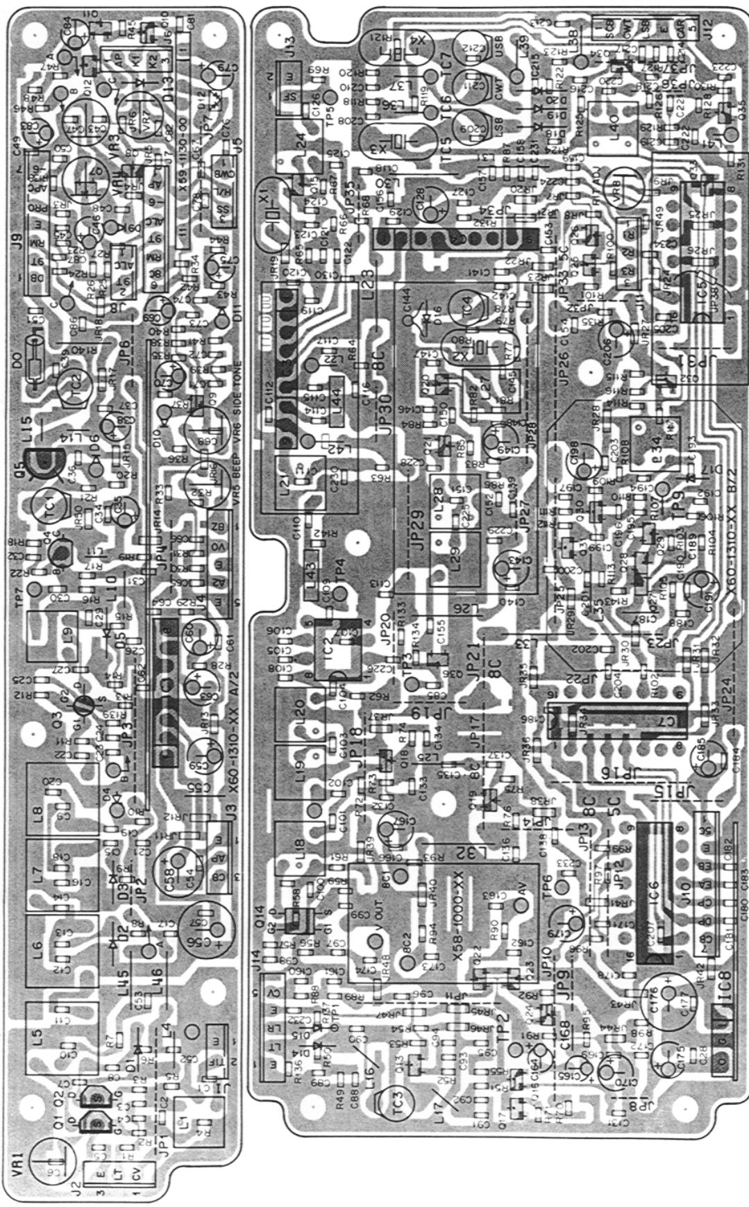
O1,2 : 2SK161(GR) O3 : 3SK741(L) O4 : 2SC2026 O5 : 2SC2638-22-A O7,9,15,17,32 : 2SC2712(Y) O8 : DTC143EK O10,12,16,25 : DTA143EK
